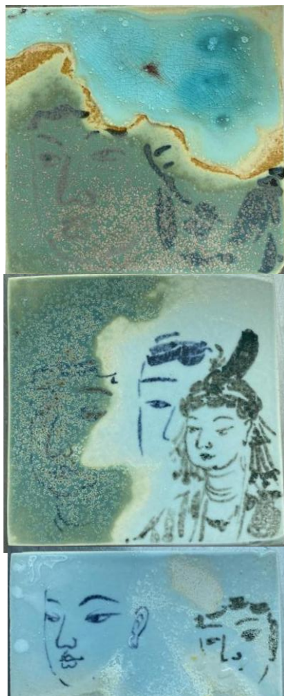
图 3-6 青花料与高温色料在颜色釉面上的发色试片
